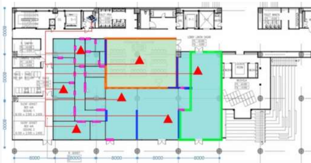
Rencana pemasangan Access Point Lantai 1
